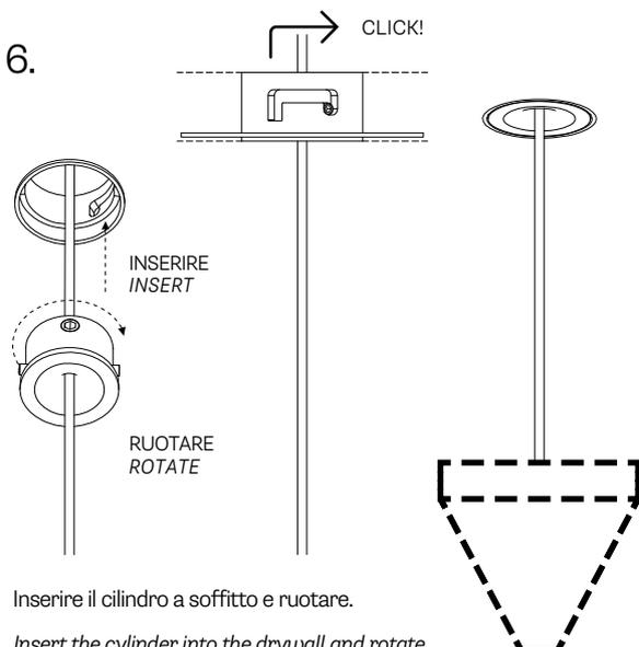
Inserire il cilindro a soffitto e ruotare.
